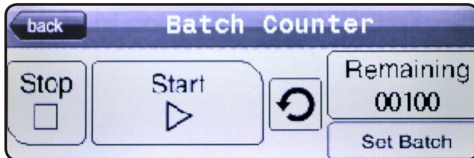
Druk op Batch Instellen rechtsonder in het batch-tellerscherm om de batch-waarde in te voeren. Het volgende scherm verschijnt:
