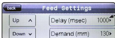
Nadat je op de On Delay-waarde hebt gedrukt, verschijnt er een nummerblok om de waarde in te voeren. De waarde moet vallen tussen 1 en 10.000 milliseconden.
