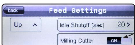
Der Schalter zeigt den augenblicklichen Status der Fräse an. Um die Fräse wieder einzuschalten, berühren Sie den Schalter erneut bis dieser wieder "ON" anzeigt.
