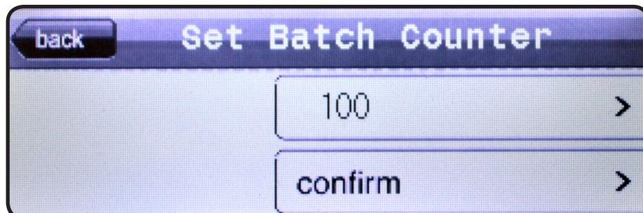
Het nummer in het bovenste vak is de huidige batch-tellerwaarde. Druk op deze waarde om hem aan te passen. Nadat je op de waarde hebt gedrukt, verschijnt er een nummerblok om de nieuwe waarde in te voeren. De waarde moet vallen tussen 1 en 10.000. Druk op Bevestigen nadat de waarde is ingevoerd om de batch-tellerwaarde in te stellen.
