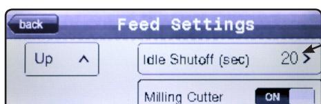
Nadat je op de Automatisch-uitschakelenwaarde hebt gedrukt, verschijnt er een nummerblok om de waarde in te voeren. De waarde moet vallen tussen 20 en 600 seconden.
