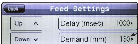
Nadat je op de On Demand-waarde hebt gedrukt, verschijnt er een nummerblok om de waarde in te voeren. De waarde moet vallen tussen 30 en 400 millimeter.
